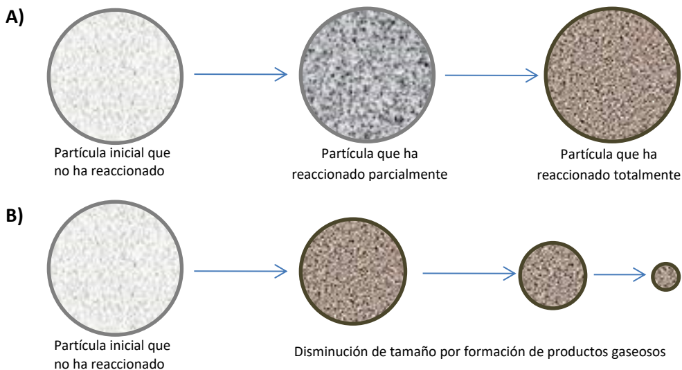
Figura 1: Representación esquemática de partículas de sólido reactivo en el curso de la reacción. A) Partículas que conservan el volumen. B) Gasificación del reactivo
